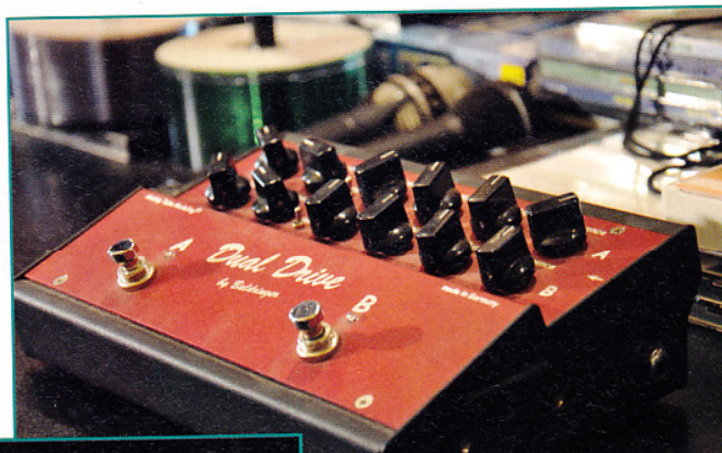
Die analoge Röhrensimulation des zweikanaligen Dual Drive hat Baldringer als Patent angemeldet. ▶
